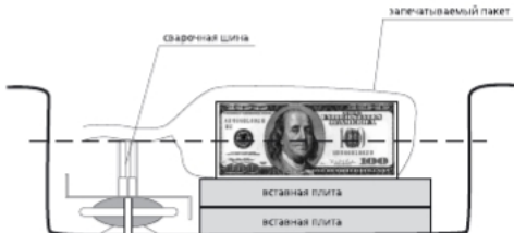
Рис. 3. Порядок укладки пачки в машину
